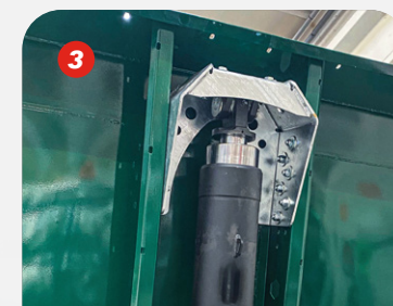
Fixation du cylindre à la caisse
