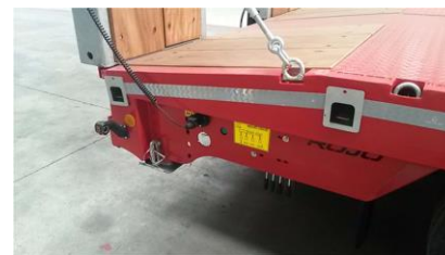
Fig. 4.6 position distributeur rampes
