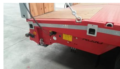
Fig. 4.9 position distributeur rampes
