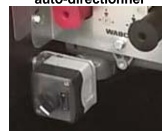
Fig. 4.12 Interrupteur en position "I"
