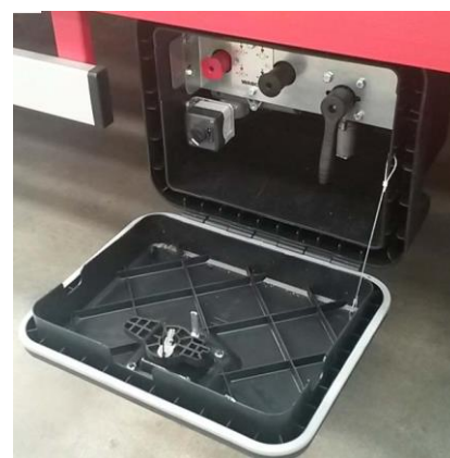
Fig. 4.5 Valve pneumatique monte/baisse
